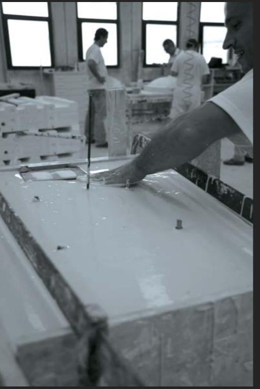
◀ P.16 - Operazione di colaggio manuale. *Manual casting labour. Operación de colado manual.*
